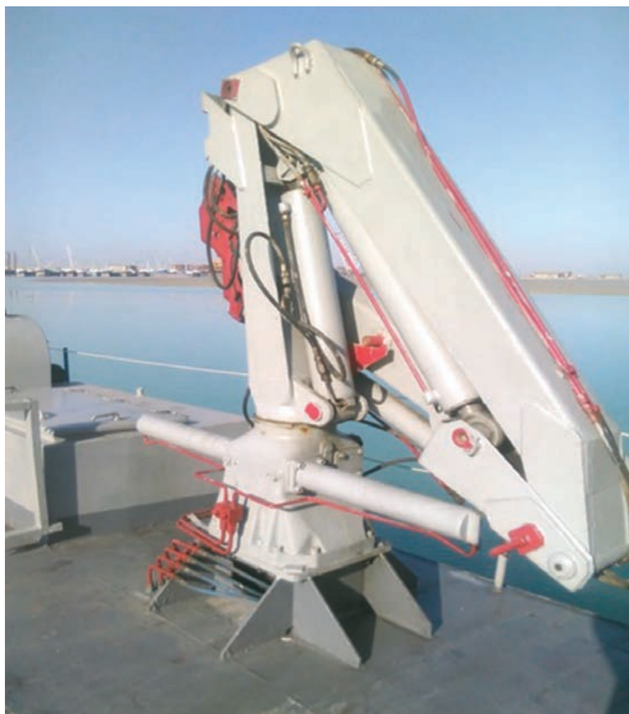
شکل ۲۲- جک هیدرولیکی بر عرشه یک شناور
