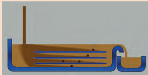
شکل ۲۰- نحوه قرار دادن صفحات موازی درون فیلتر
