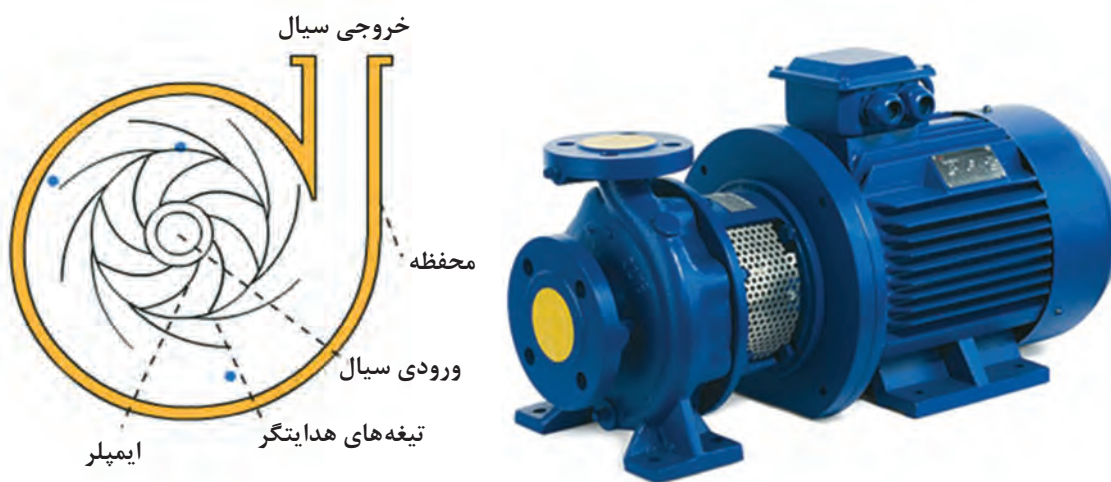
شکل ۵- پمپ گریز از مرکز
